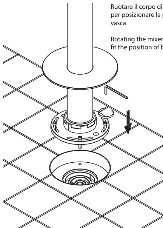
Ruotare il corpo di  $\pm 27^\circ$
