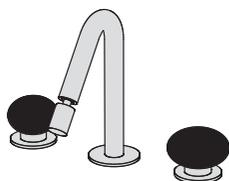
Set per bidet tre fori composto da due comandi piantana con vitone ceramico e bocca di erogazione girevole (160°) con snodo senza salterello e scarico
