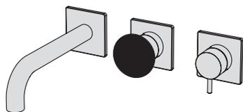
Parte estetica per miscelatore vasca incasso meccanico con deviatore 2 vie integrato e bocca di erogazione fissa L=190 mm, per installazione orizzontale
