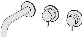
Parte estetica per miscelatore vasca incasso meccanico con deviatore 3 vie integrato e bocca di erogazione fissa L=190 mm, per installazione orizzontale
