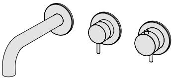
Parte estetica per miscelatore vasca incasso termostatico con deviatore 2 vie integrato e bocca di erogazione fissa L=190 mm, per installazione orizzontale
