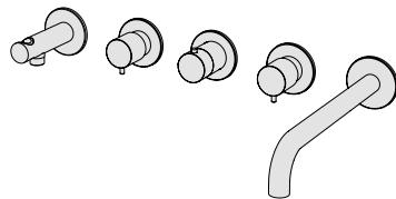
Parte estetica per kit vasca orizzontale incasso a muro formato da miscelatore termostatico, bocca di erogazione fissa, due rubinetti di arresto e presa acqua con supporto, con raccordi da 3/4"
